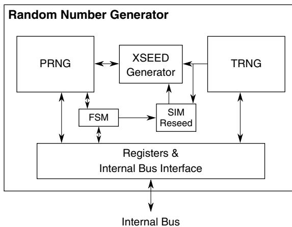
**Figure 28-1. RNG Block Diagram**
