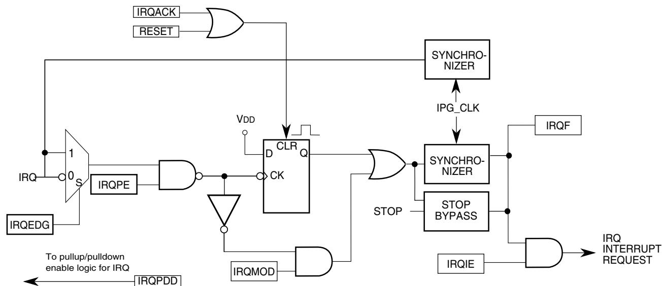
**Figure 50-1. IRQ Block Diagram**
