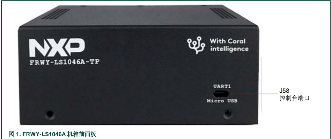
图 1. FRWY-LS1046A 机箱前面板
